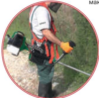
Двухтактный двигатель. Двигатель с высоким крутящим моментом и с мощностью 2,0 Л.С. работает с максимальной производительностью при обрезке травы, веток, газона и т. д.
