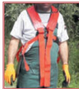
Ремень Рюкзак. Плечевые трехточечные ремни фиксируют ее в безопасном положении и обеспечивают дополнительный комфорт, так как уменьшают нагрузку на спину и плечи оператора.
